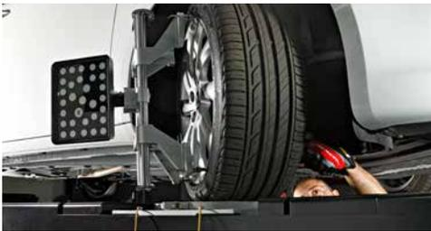
Функция EZ-TOE обеспечивает полный доступ к трудно доступным узлам регулировки схождения передних колёс
